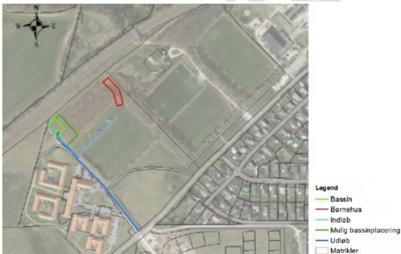
Figur 1. Lufifoto over området, hvor placeringen af børnehuset og det nye regnvandsbassin er skitseret med hhv. rød og lysegrøn. Derudover er regnvandsledningen fra børnehuset og til regnvandsbassinet, samt regnvandsledningen fra bassinet og til Fors A/S' eksisterende regnvandskloak fra Plejecenter Bøgebakken vist med lyseblå, hhv. mørkeblå. Regnvandsbassinet samt de viste regnvandsledninger vil blive drevet og vedligeholdt af Fors A/S.
