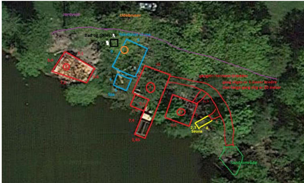
Figur 2. situationsplan - det ansøgte projekt. Det med rødt angiver terrasserne (1,2 & 3), gangsti og badebro, placeringen af sauna er vist med gul, spa og teknikum er angivet med blå, udebruser med orange, skur med toilet og bad er vist med sort, areal hvor der udlægges sand er vist med grøn og jordvold er vist med lilla (jordvolden bliver kortere end ansøgt - se vilkår).
