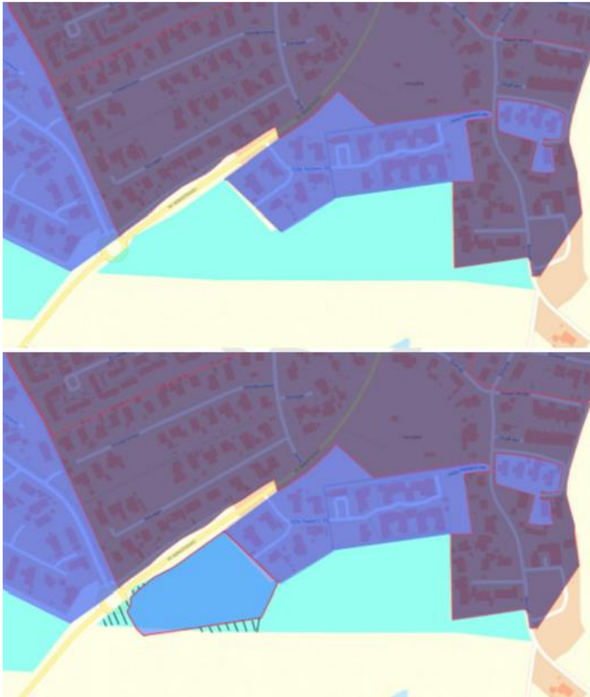
Figur 1. Det øverste kort viser de nuværende kloakoplande omkring børnehushets matrikel i spildevandsplanen. Det nederste kort viser kloakopland HV31 efter at det er blevet ændret således, at det fremover vil omfatte hele det kommende nye erhvervsområde. Fra forslaget til tillæg 27.
