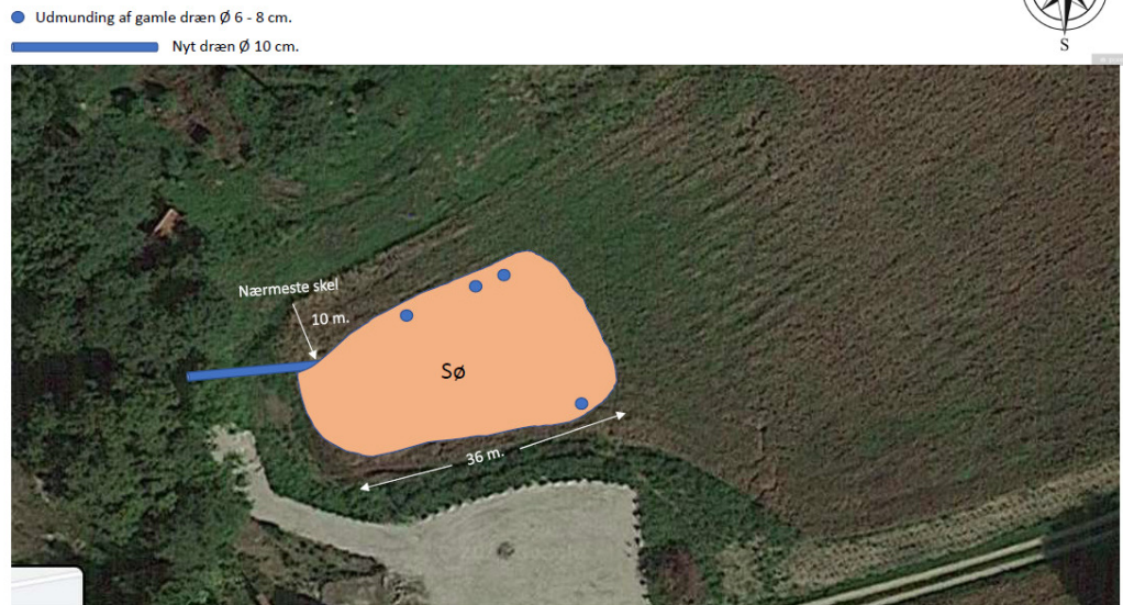
Figur 1. Tegning af den nye sø med 4 gamle dræntilløb og nyt drænafløb til Møllebækken
