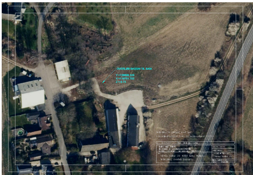
Figur 4. Orthofoto med angivelse af kote ca. 9,73 meter (DVR90) på terræn for overløb fra sø til bæk. Bund af drænafløb på ø 8 cm placeres i kote ca. 9,53 meter (DVR90)
