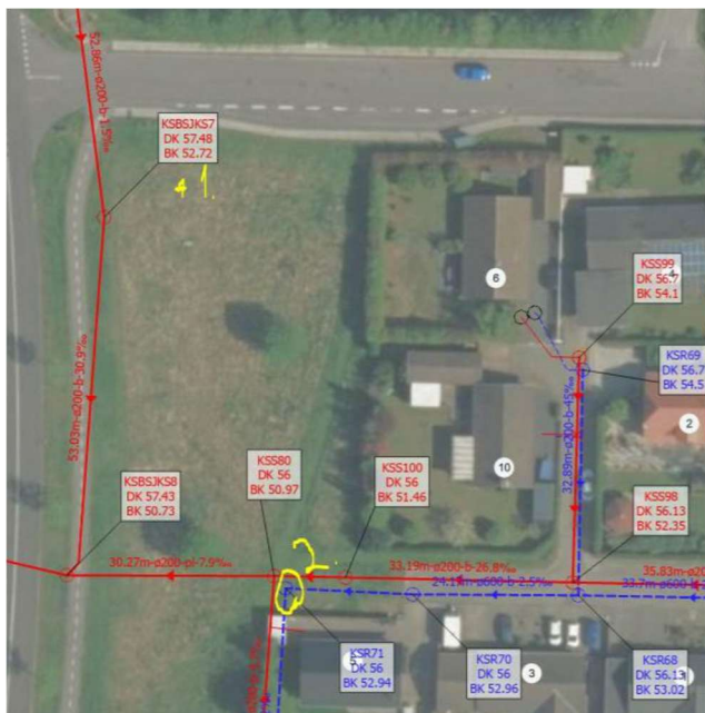
Figur 1. Luftfoto over projektområdet, med markering af boringen (1) samt brønden hvor det oppumpede grundvand ønskes ledt til regnvandskloakken (2). Derudover er regnvandskloakken vist med stiplede blå, og spildevandskloakken er vist med fuldt optrukne røde.
