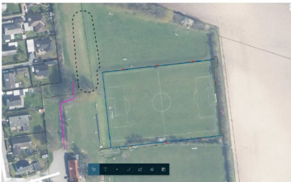
Figur 1 Situationsplan over kommende kunstgræs anlæg med hegn og lysanlæg samt ny jordvold. Rød = boldhegn 4 m, blå = boldhegn 1 m, sort = terræntilpasning, rød prik = lysmast, magenta = støjvæg.
