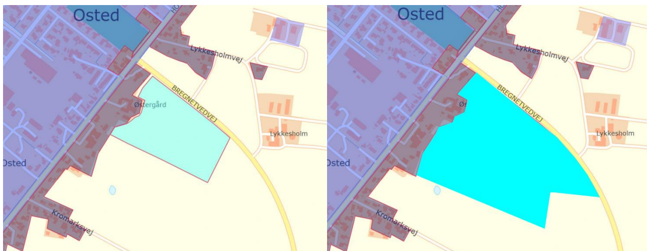
Figur 1. Kortet til venstre viser kloakopland OS38 i sin nuværende udstrækning. På kortet til højre er kloakopland OS38 ændret således, at dets udstrækning er sammenfaldende med afgrænsningen af den ubebyggede del af lokalplanområde LK 92. Ændringen vil således ikke berøre de ejendomme langs med Hovedvejen, som er medtaget i lokalplanen, da disse i forvejen ligger i kloakopland.
